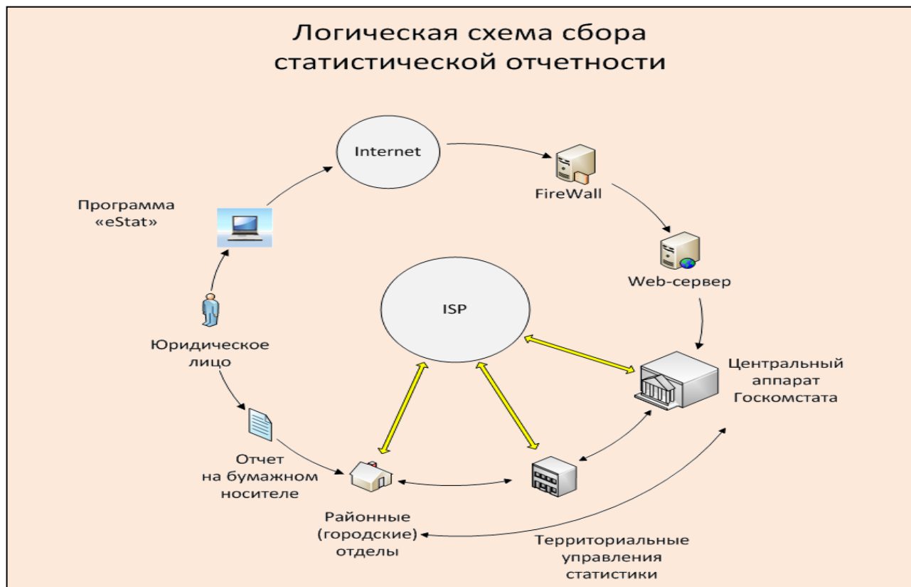
Рис. 2. Логическая схема сбора и обработки статистической отчетности.
