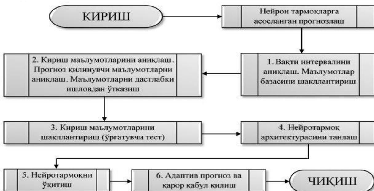
**1-расм. Нейротармоқ асосида технологик прогнозлаш циклининг блок-схемаси**
