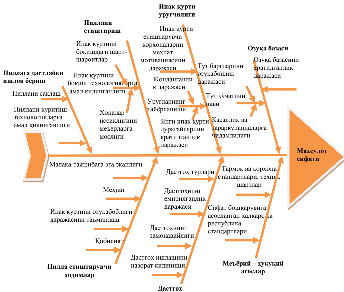
Расм. Хом ипак ипини ишлаб чиқаришда уни сифатига таъсир этувчи омил ва сабаблар, оқибатлар диаграммаси[7].
