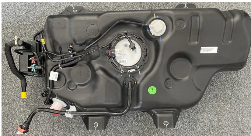
1-rasm. Onix va Tracker modeli plastik yoqilg‘i baki – 24 dona asosiy butlovchi qismdan iborat, detallari soni 100 dan ortiq.
